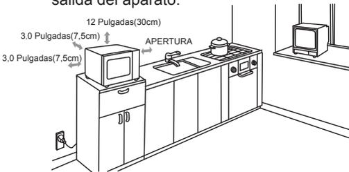
Se requiere de un claro mínimo de 3,0 pulgadas (7,5cm) entre el horno y cualquier pared adyacente. Un lado debe estar despejado.
